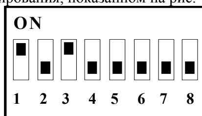
Рис. 4. Пример установки адреса БУЗ
