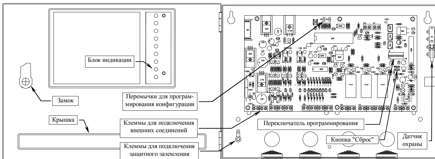
Рис. 2. Расположение блоков в БУЗ
